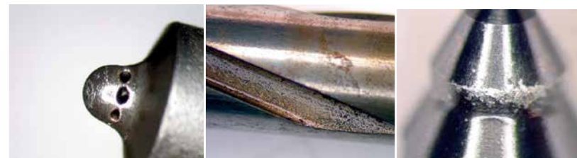
Rys. 3. Uszkodzenia elementów funkcjonalnych rozpylacza: 1 - rozbiście otworów rozpylających, 2 - korozja zmęczeniowa powierzchni igły, 3 - uszkodzenie średnicy przyłgni igły.
