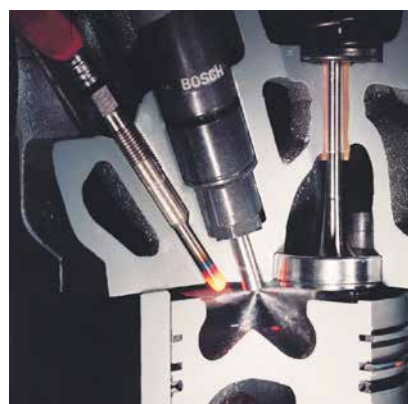
Rys. 2. Wtrysk rozpylonej dawki paliwa do komory spalania z wykorzystaniem wtryskiwacza CR.
