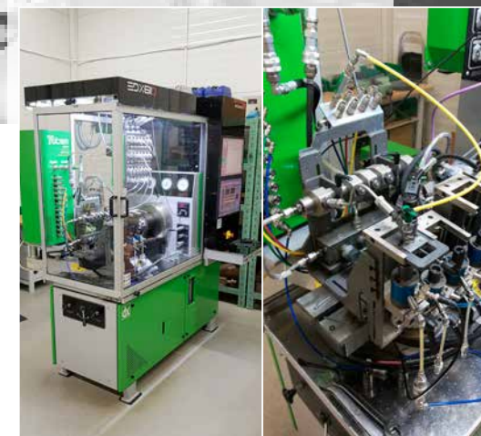
Rys. 5. Stanowisko do badania charakterystyk wtryskiwaczy Common Rail oraz rzut na zamontowany wtryskiwacz w uchwycie stołu probierczego.
